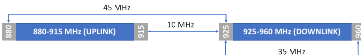
Ilustración 18. Canalización banda 900 MHz.
